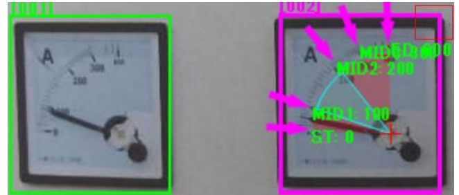
右側のメータを読むためにさらにもう一つ検査枠を追加します。
