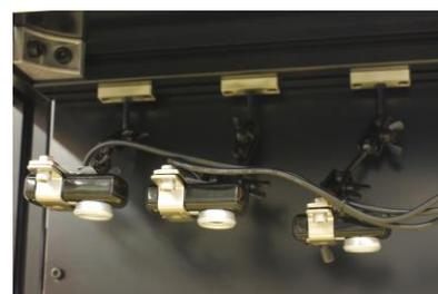
スライドレールに取り付けられたフレキシブルアーム。カメラおよび照明灯の位置と角度が自由に設定できます。
