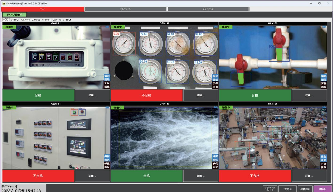
Gambar dimuat, pembacaan dan pendeteksian objek dilakukan dengan software pemrosesan gambar lalu dinilai, sehingga pekerjaan yang selama ini manual dapat diotomatisasikan.
