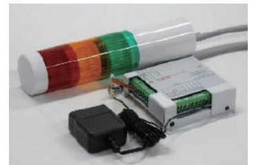
หน่วย I/O อัจฉริยะและไฟสัญญาณ
