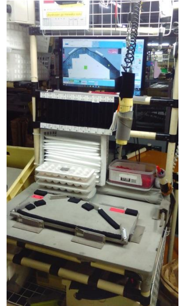
成形品への部品誤組付け、欠品の検出
