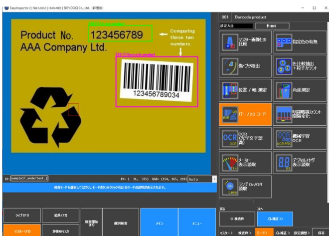
OCR の読み取りとバーコードでの読み取り文字を比較
